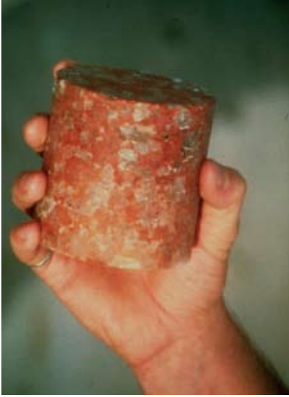
ภาพที่ 3.1 ตัวอย่างแร่โพแทช (Potash Ore) ที่มา: Saskatchewan Mining Association ( www.saskmining.ca/photolip?SEC=PO )
