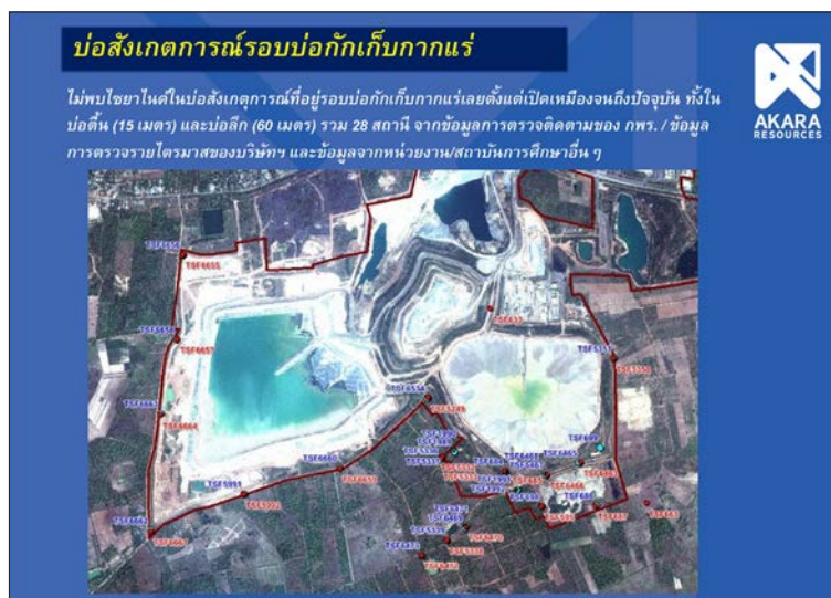
รูปที่ 1-7 มาตรการติดตามตรวจสอบคุณภาพสิ่งแวดล้อมน้ำผิวดิน
